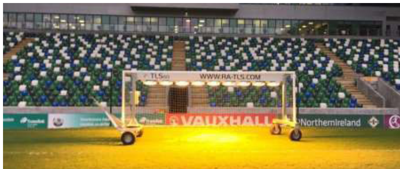
Rys. 33 Lampy do naświetlania murawy stosowane w celu zwalczania skutków zacienienia
