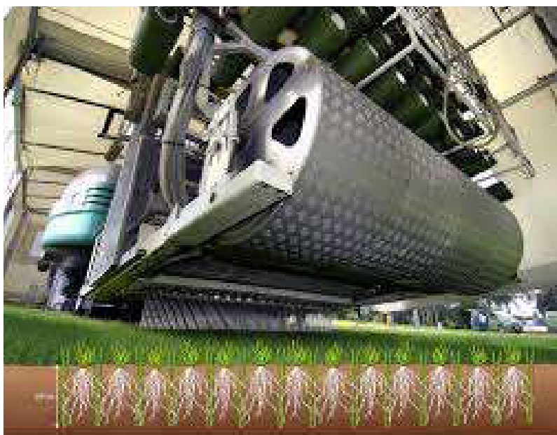
Rys. 16 Montaż trawy hybrydowej
