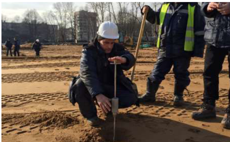
Rys. 5 Testowanie zwięzłości warstwy nośnej murawy
