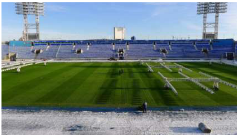
Rys. 34 Lampy do naświetlania murawy używane w celu regeneracji trawy w okresie wiosennym; ciepło wytwarzane przez lampy pozwala również na przywrócenie trawy do poprzedniego stanu
